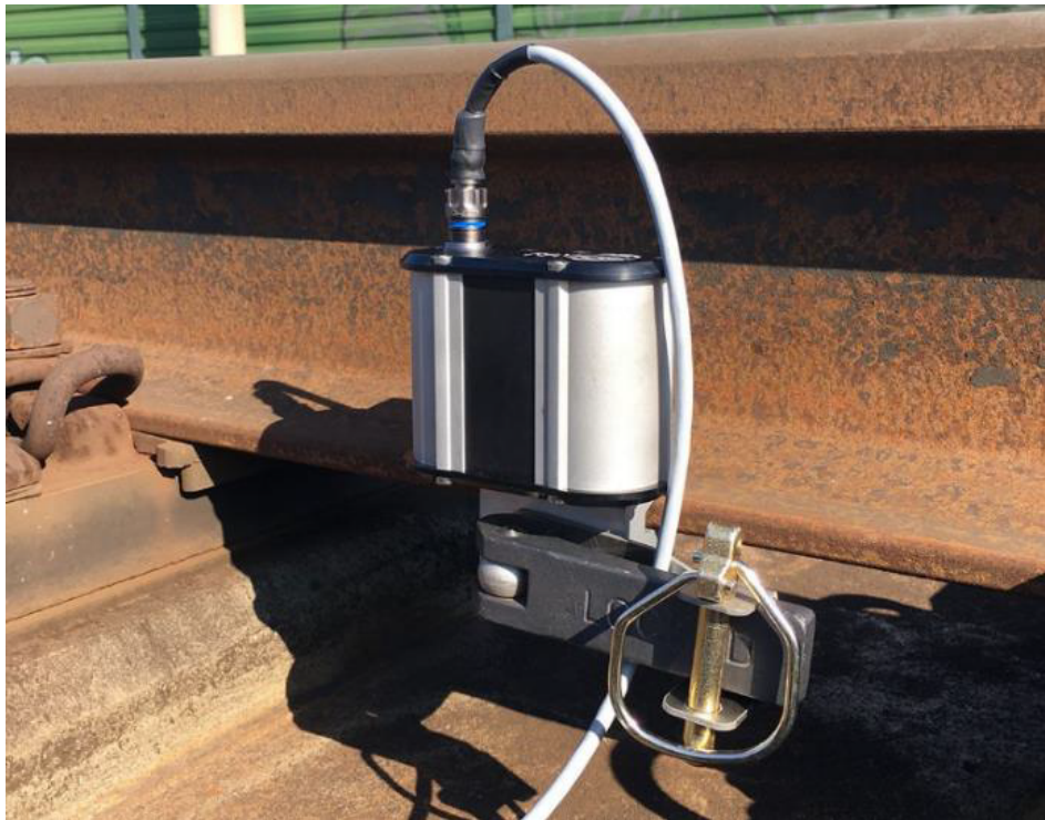
Obrázek 3.11: Železniční aplikace rezonátoru firmy ReVibe [17]
