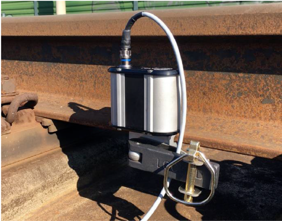
Obrázek 3.11: Železniční aplikace rezonátoru firmy ReVibe [17]
