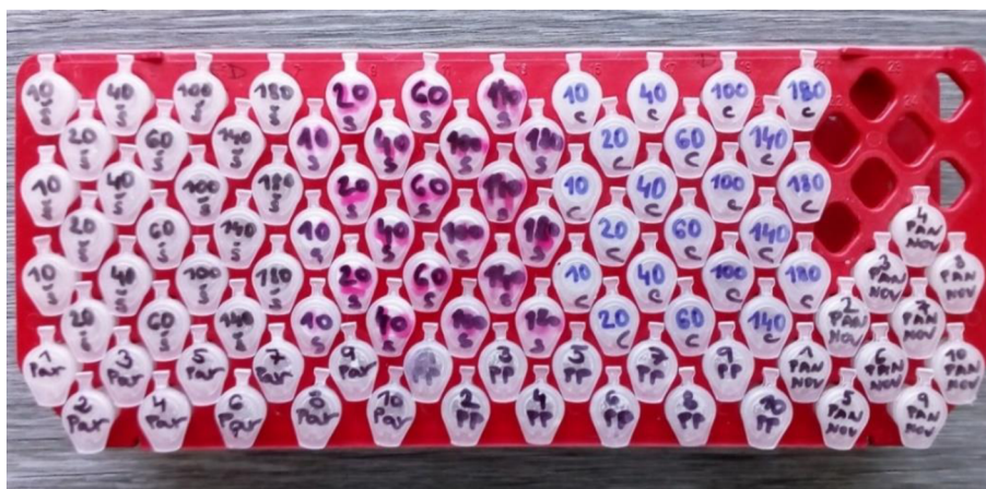
Obrázok 9. Vzorky plniv s paracetamolom a vzorky tabliet liečivých prípravkov pripravené na meranie
