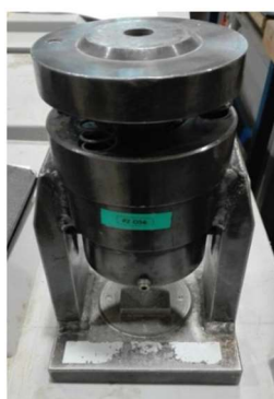
Obrázek 25: Přípravek na zkoušení pevnosti v tlaku
