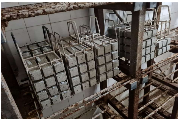
Obrázek 31: Uložení vzorků po dobu 28 dní
