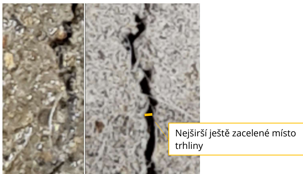
Obrázek 38: Ukázka volby nejširšího ještě zhojeného místa
