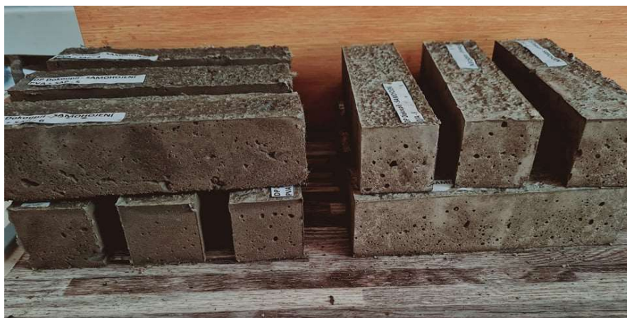
Obrázek 30: Odformované vzorky PVA+SAP (nalevo) a PVA (napravo)
