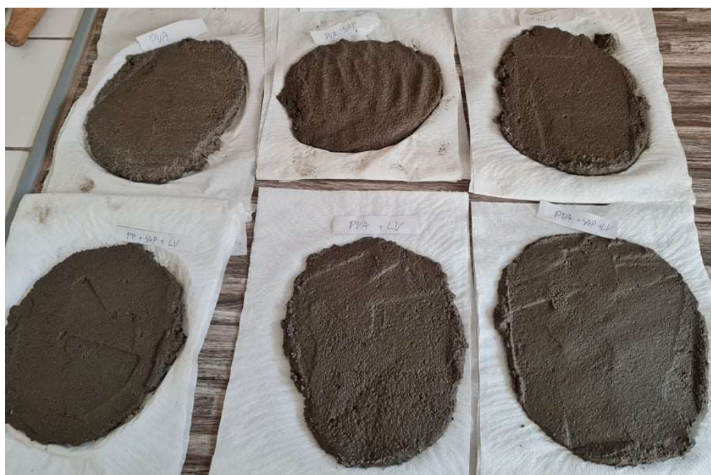
Obrázek 27: Ukázka vytvořených koláčů pro ověření rozmísení mikrovláken
