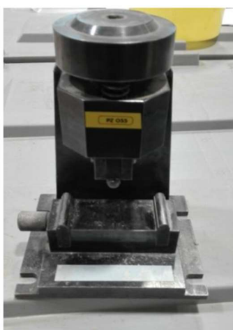
Obrázek 24: Zkušební přípravek pro vyvození tříbodového ohybu
