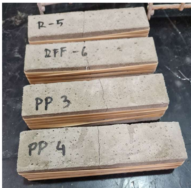
Obrázek 33: Ukázka připravených vzorků po sestavení polovin
