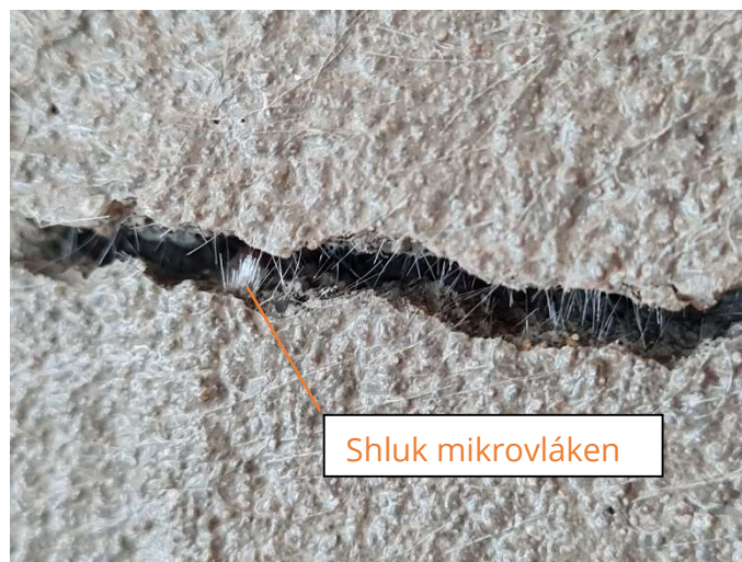
Obrázek 29: Nerozmísený shluk mikrovláken
