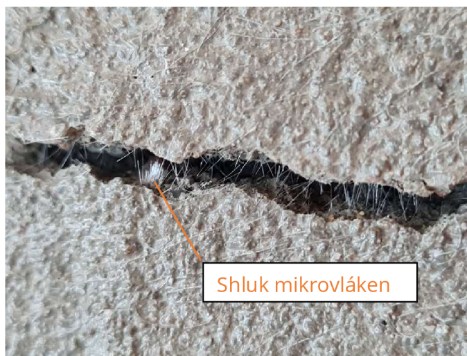
Obrázek 29: Nerozmísený shluk mikrovláken
