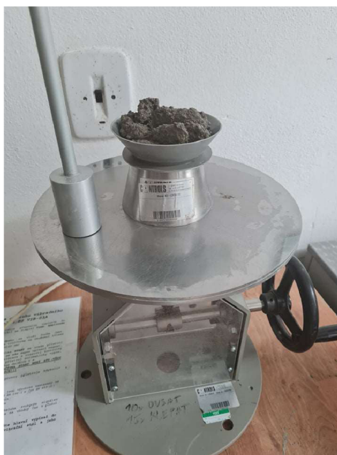
Obrázek 20: Střásací stůlek pro zkoušení cementových malt
