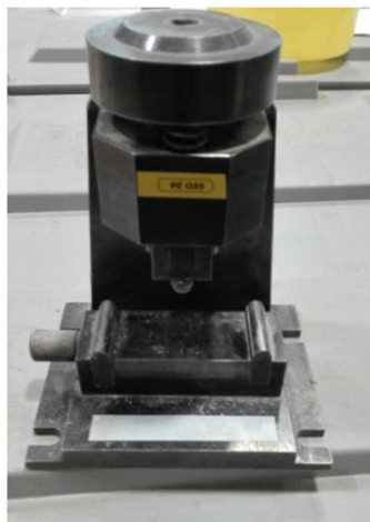
Obrázek 24: Zkušební přípravek pro vyvození tříbodového ohybu
