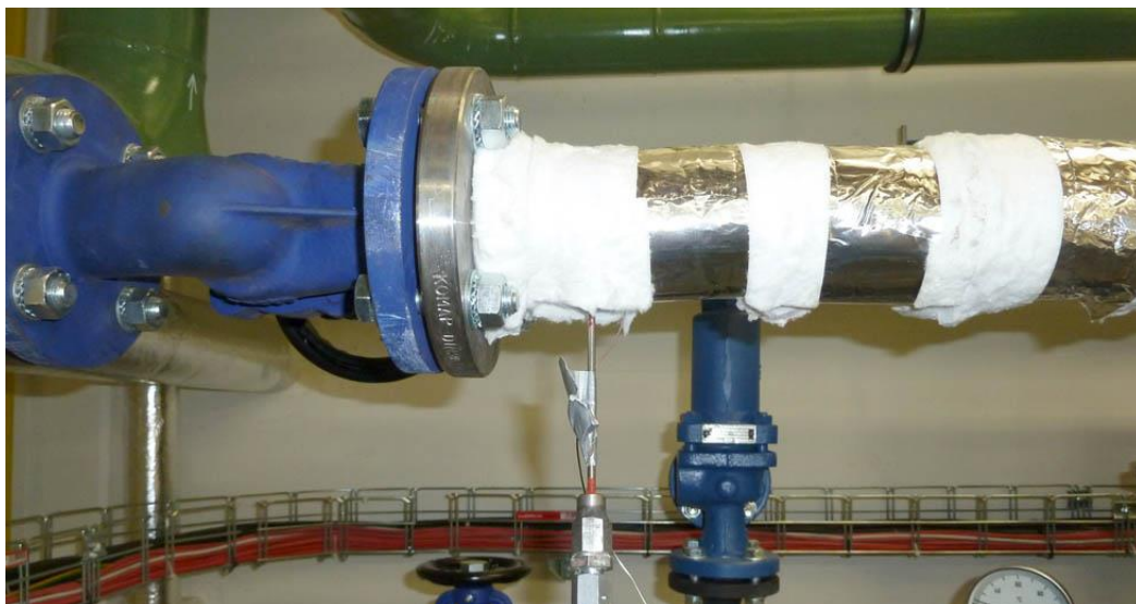
Obr. 26 Detail umístění sondy P1 a termočlásku T4
