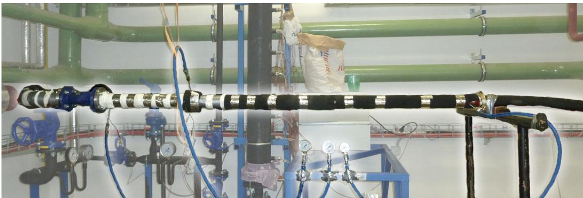
Obr. 25 Měřicí oblast (zvýrazněna), v popředí uprostřed tři deformační manometry
