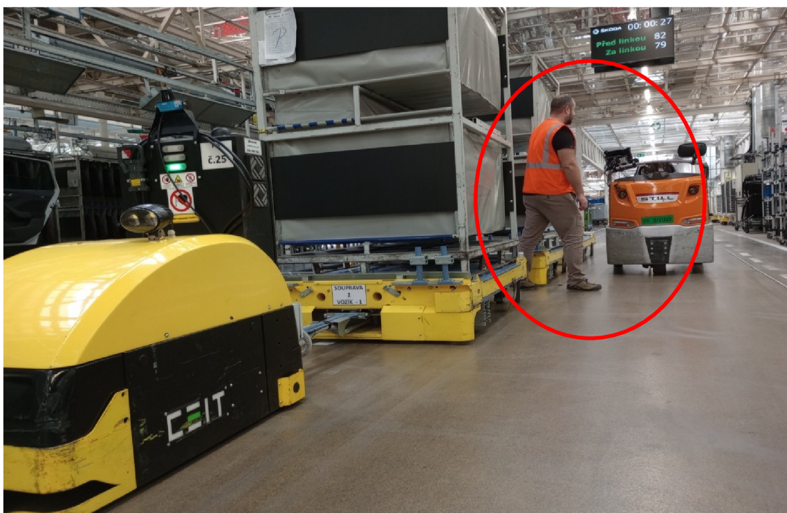
Obr. 3.8 Příklad nepovoleného vstupu do vozovky
