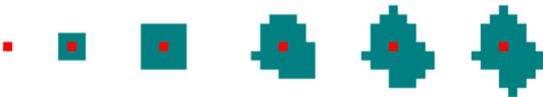
Obrázek 2.9: Základním principem růstového algoritmu je iterativní připojování pixelů do plochy koruny.
