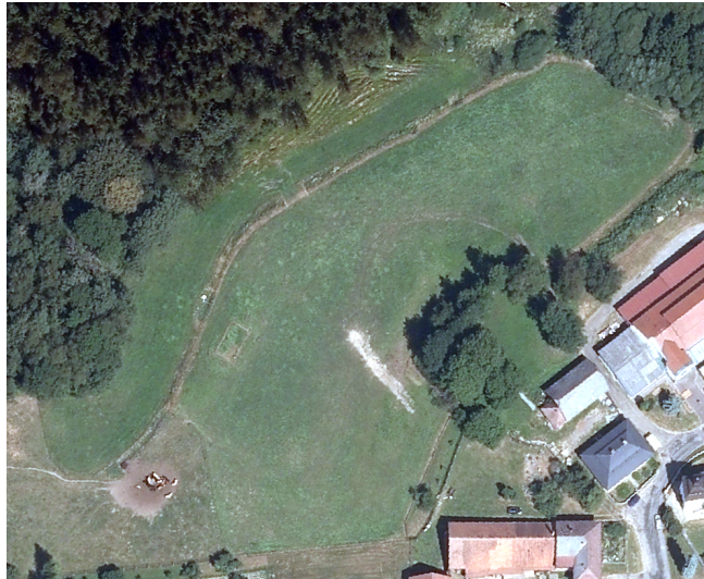
Obrázek 1.4: Letecký snímek vysokého prostorového rozlišení. Při zobrazení v pravých barvách není rozdíl oproti klasické fotografii. Je třeba mít na paměti, že u hyperspektrálních dat máme pro každý pixel k dispozici informace o celém spektru odrazivosti v jisté škále vlnových délek. Viz též obrázek 1.5.
