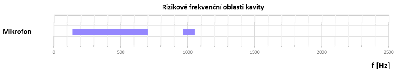
Obr. 8.45 Rizikové frekvenční oblasti pramenící z rezonančních vlastností kavity
