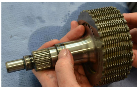
Obr. 8.10 Uspořádání lamel v systému Haldex
