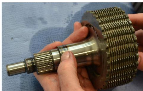
Obr. 8.10 Uspořádání lamel v systému Haldex
