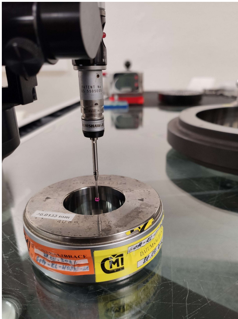
Obr. 45: Meranie nastavovacieho krúžku SIP [autor]
