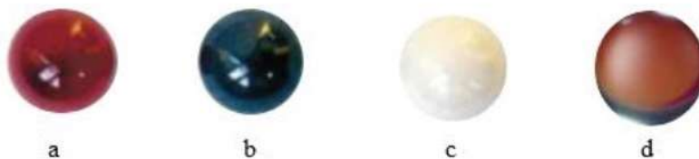
Obr. 20: Materiál guľôčky dotyku: a) rubín b) nitrid kremíka c) oxid zirkoničitý d) diamant [14]
