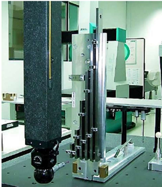
Obr. 24: Kalibrácia portálového CMM pomocou koncových mierok [27]
