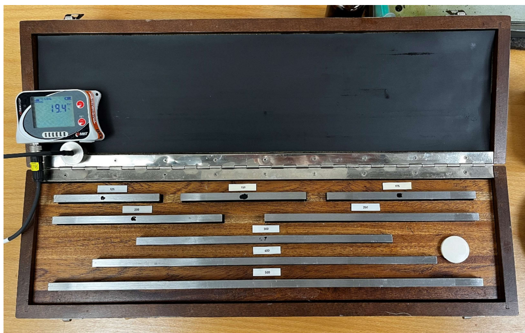
Obr. 38: Sada oceľových koncových mierok Frank (125÷500) mm [autor]
