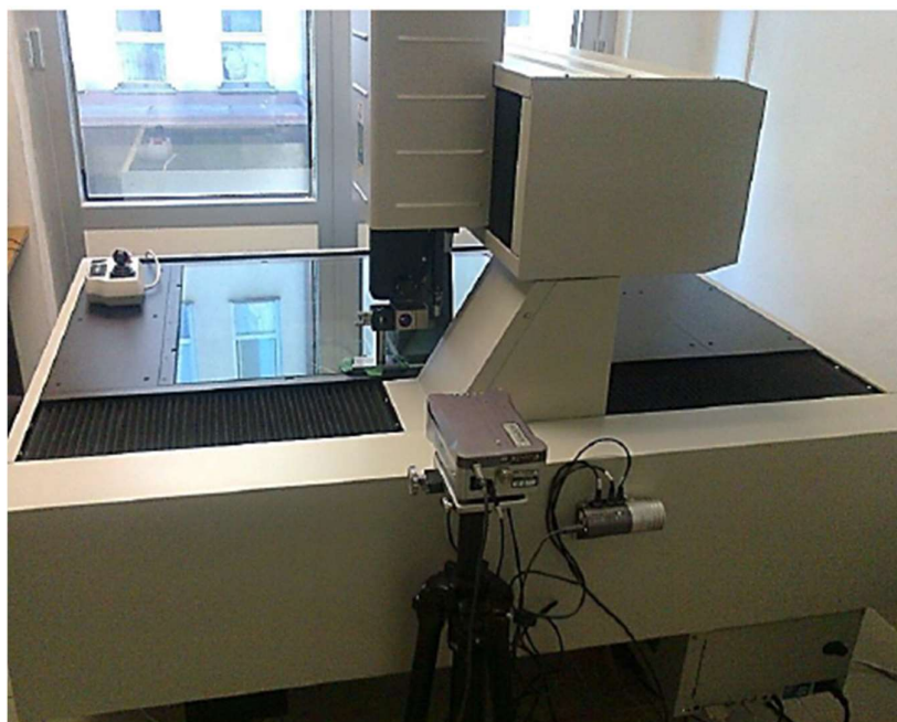
Obr. 25: Kalibrácia CMM pomocou laserového interferometra [46]
