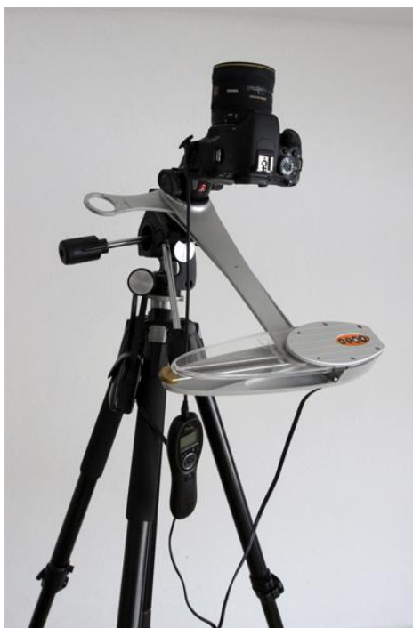
Obr. 15: Snímek celooblohové fotosestavy umožňující měření jasu oblohy. Fotoaparát se širokoúhlým objektivem je připojen na montáži Astrotrac. Sestava je dále připevněna k fotografickému stativu.
