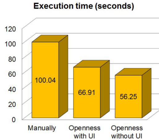
Obr. 3.1: Porovnání efektivity mezi manuálním a automatickým provozem [12]
