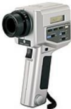
Obr. 8: Příklad jasoměru. Převzato z www.anamet.cz/jasomery . Výrobce neudává rozměry výrobku.
