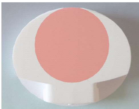
Obr. 51: Porovnání staré clonky (bílá barva) a k ní dokreslené modifikované clonky (červená barva). Foto a grafika Mgr. Martin Vacula.
