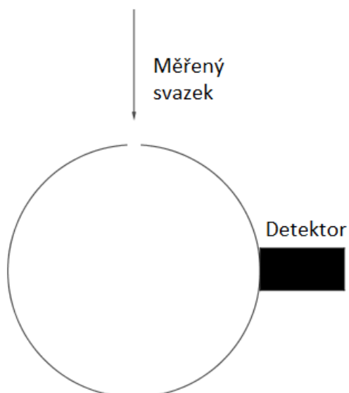
Obr. 18: Měření intenzity (zářivého toku) svazku bez přítomnosti vzorku.
