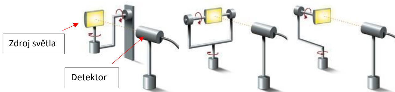
Obr. 6: Schematická uspořádání goniofotometrů typů A, B, C v pořadí zleva. Převzato z [7].
