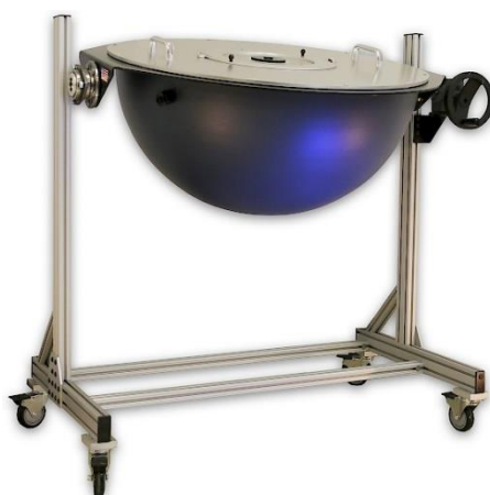
Obr. 21: Příklad tzv. měřicí polokoule. Převzato z http://www.labsphere.com .
