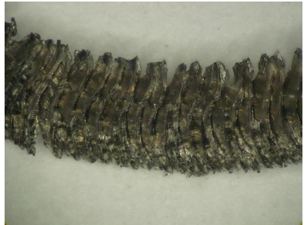
Tvar a štruktúra triesky po 4,4 min.
