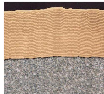
Obr. 4.5 Povlak 4. generácie (Valenite USA) [24].
