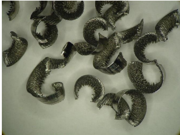
Obr. 5.18 Segmentovaná trieska po 2 minútach v reze.
