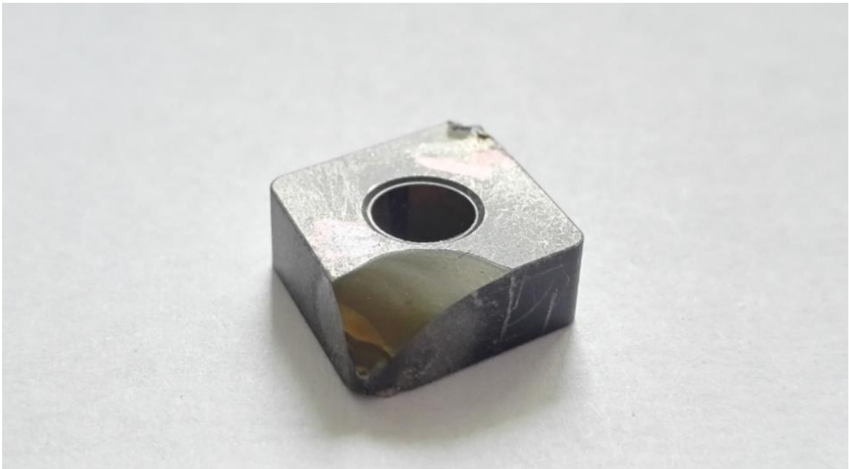
Obr. 5.13 Krehký lom reznej hrany, po teste 4.
