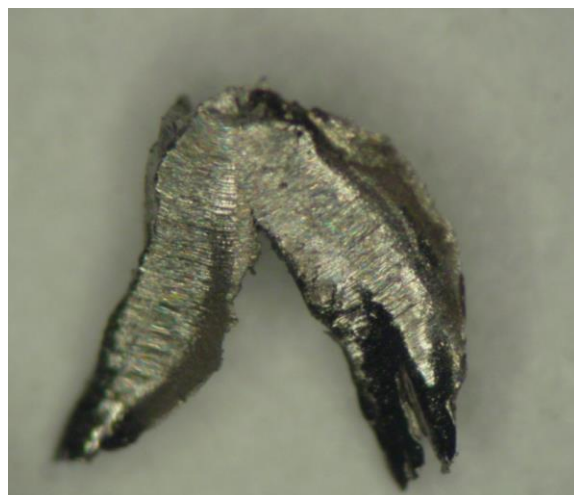
Nová VBD, tvar a štruktúra triesky na začiatku obrábania.
