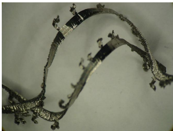
Tvar a štruktúra triesky po 6,5 min.
