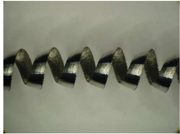
Obr. 5.19 Trieska, vznikajúca na konci trvanlivosti reznej hrany.
