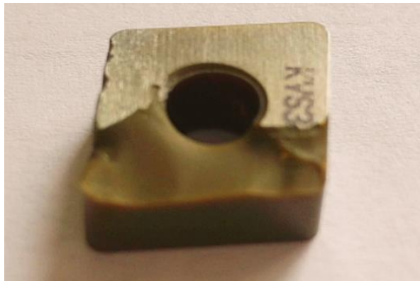
Obr. 5.10 Krehký lom po teste 1.
