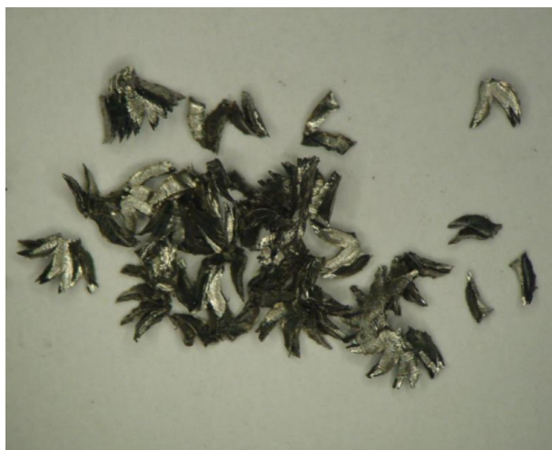
Nová VBD, tvar a štruktúra triesky na začiatku obrábania.
