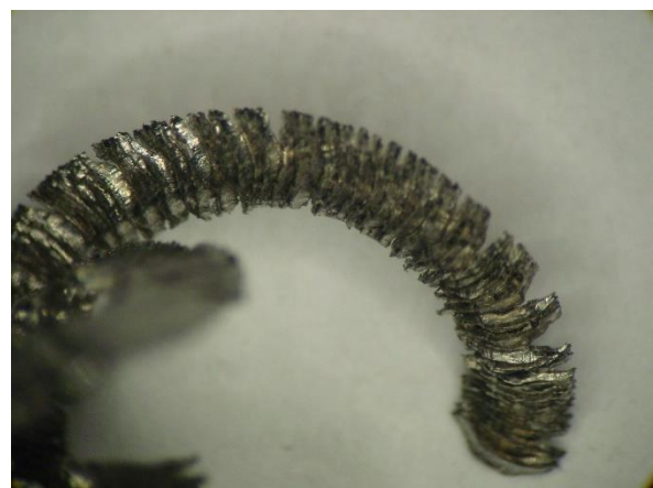
Tvar a štruktúra triesky po 3,5 min.
