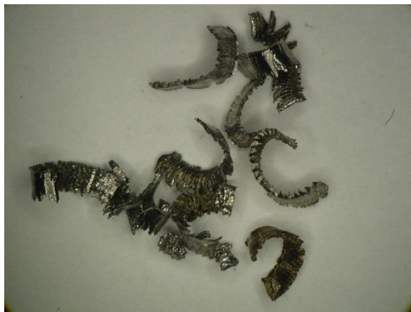
Tvar a štruktúra triesky po 2,2 min.
