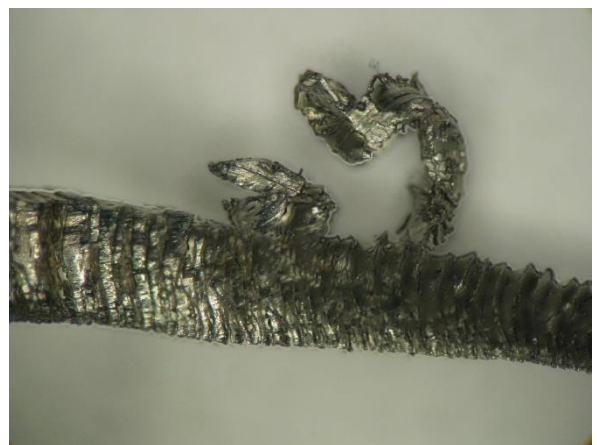
Tvar a štruktúra triesky po 6,5 min.
