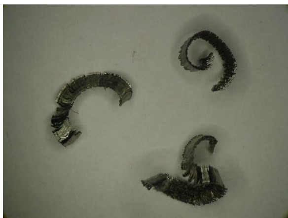
Tvar a štruktúra triesky po 3,5 min.
