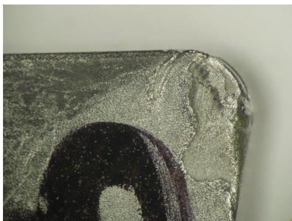
Opotrebenie čela (vľavo) a chrbta (vpravo) VBD po 4,4 min.
