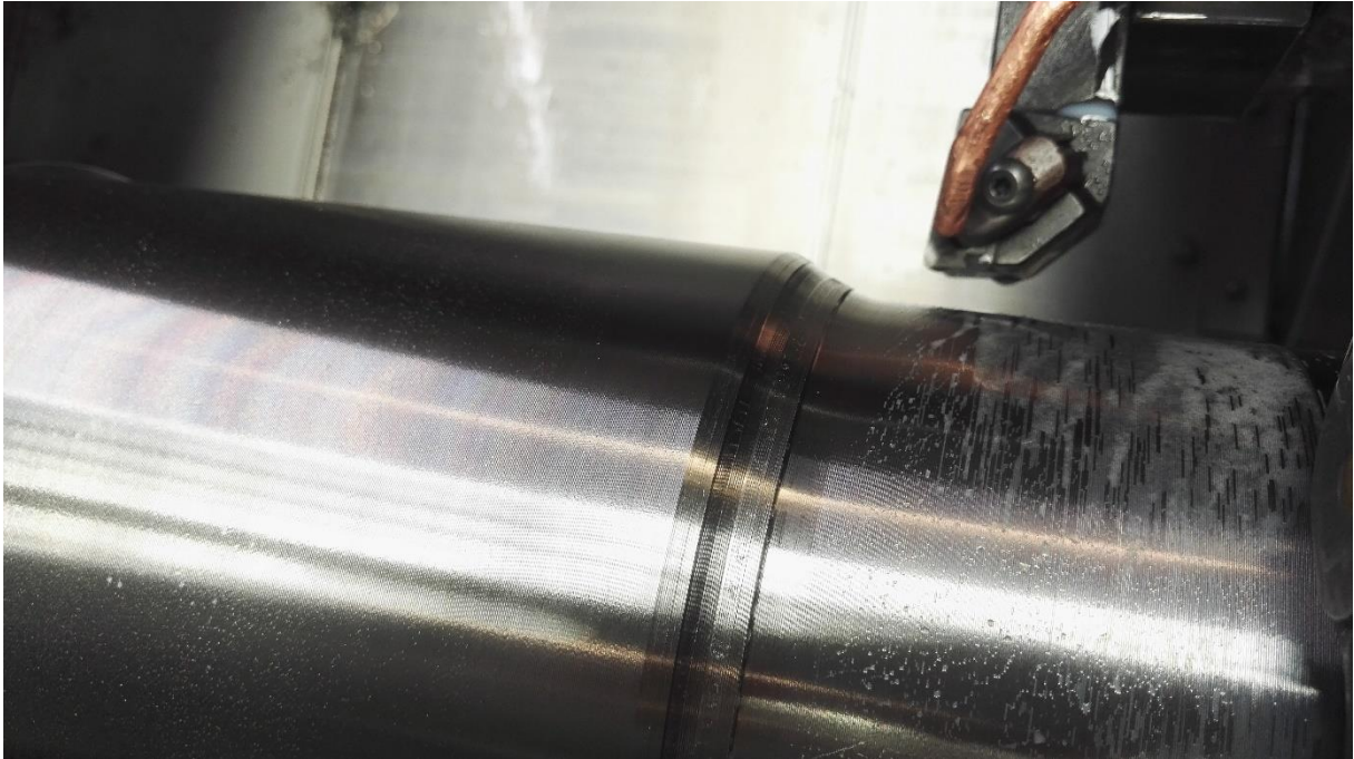
Obr. 5.8 Prívod procesnej kvapaliny do miesta rezu.
