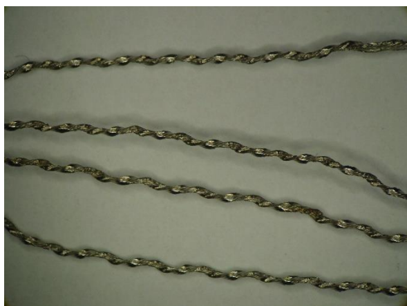
Opotrebená VBD, tvar a štruktúra triesky na konci trvanlivosti reznej hrany.
