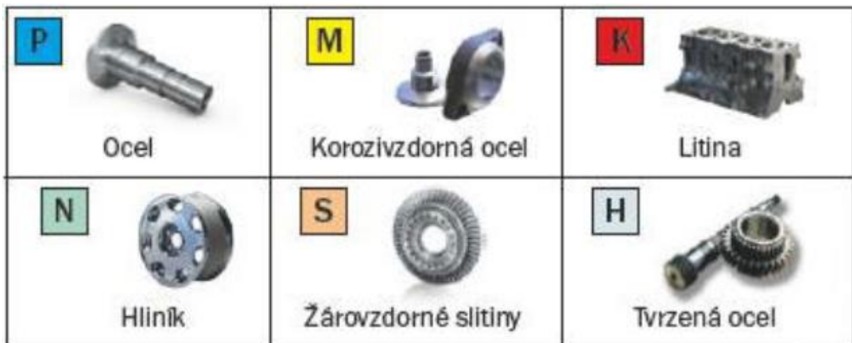
Obr. 4.10 Rozdelenie spekaných karbid podľa použitia na materiál obrobku [11].
