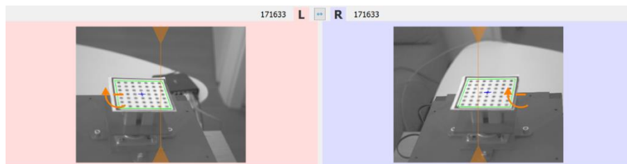
Obrázok 51 Nesprávne nastavenie pootočenia kamier
