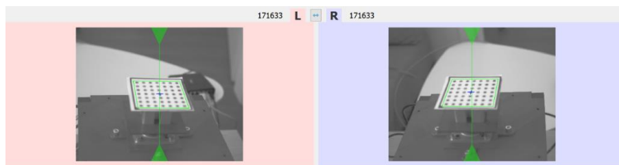
Obrázok 52 Správne nastavenie pootočenia kamier
