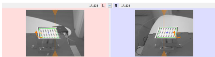
Obrázok 51 Nesprávne nastavenie pootočenia kamier
