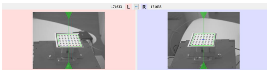
Obrázok 52 Správne nastavenie pootočenia kamier
