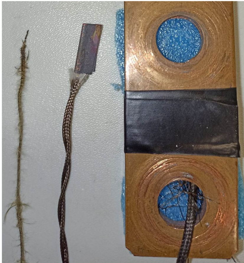
Obr. 2.2: Provedení termočlánků v laboratoři spínacích přístrojů
