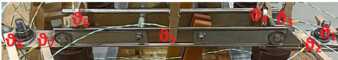
Obr. 7.5: Umístění termočlánků na odpojovači
