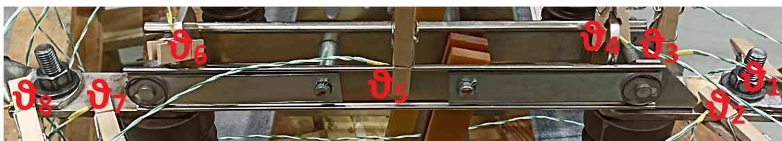
Obr. 7.5: Umístění termočlánků na odpojovači
