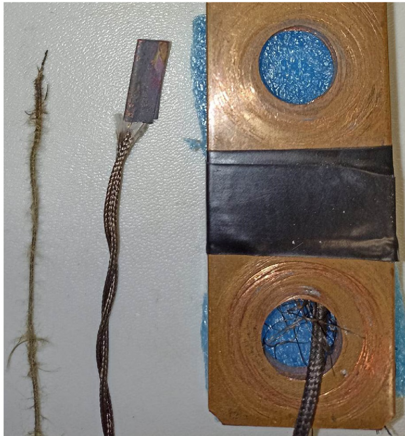
Obr. 2.2: Provedení termočlánků v laboratoři spínacích přístrojů
