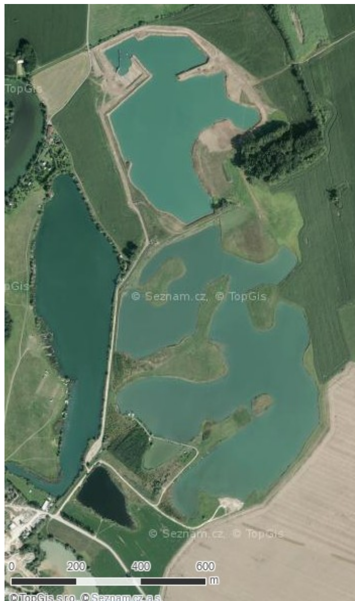
Ilustrace 8: Letecký snímek z roku 2015 ukazuje stav na zkoumaném ložisku 7 let po ukončení těžby a všech fází rekultivace a započetí nové těžby v severní části lokality (na obrázku nahoře). Zdroj: mapy.cz
