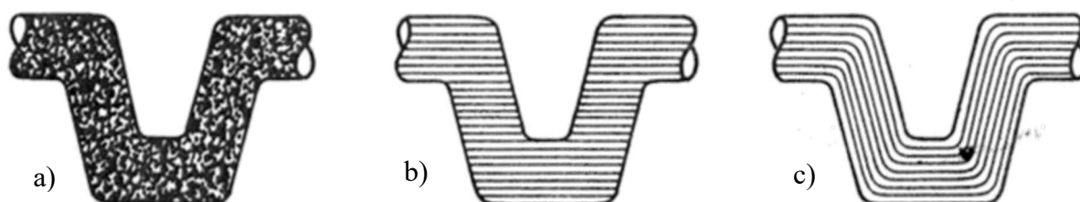
Obr. 7 Vnútoraná štruktúra materiálu v závislosti na technológii výroby [16]
