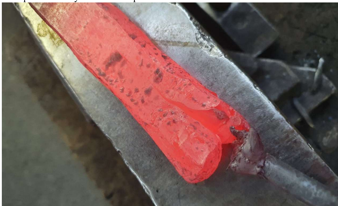
Obr. 61 Porušenie po stlačovaní
