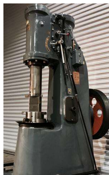
Obr. 17 Pneumatický dvojčinný buchar [33]
