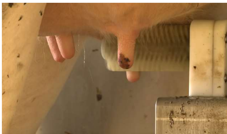
Obrázek 9 - Čištění struků pomocí rotujících válečků (TVFBrno, 2018)
