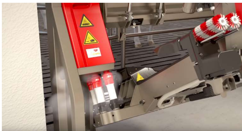
Obrázek 16 - Dezinfekce strukových násadců parou (Lely, 2018)
