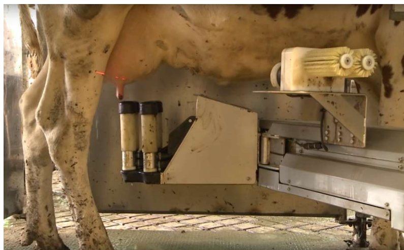
Obrázek 7 - Fullwood Merlin zaměřování struků laserem (TVFBrno, 2018)
