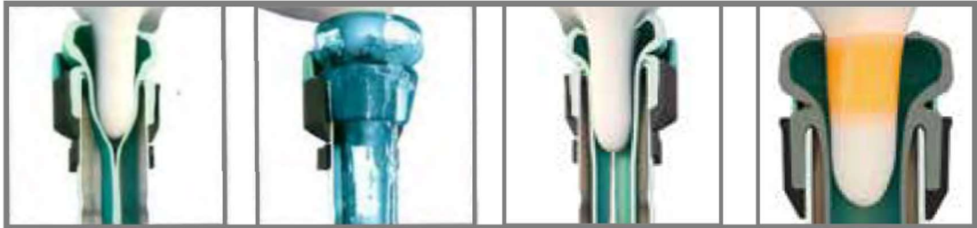
Obrázek 18 - Procesy po nasazení strukové návlečky: stimulace, očištění, dojení, dipování (GEA brožura, 2016)
