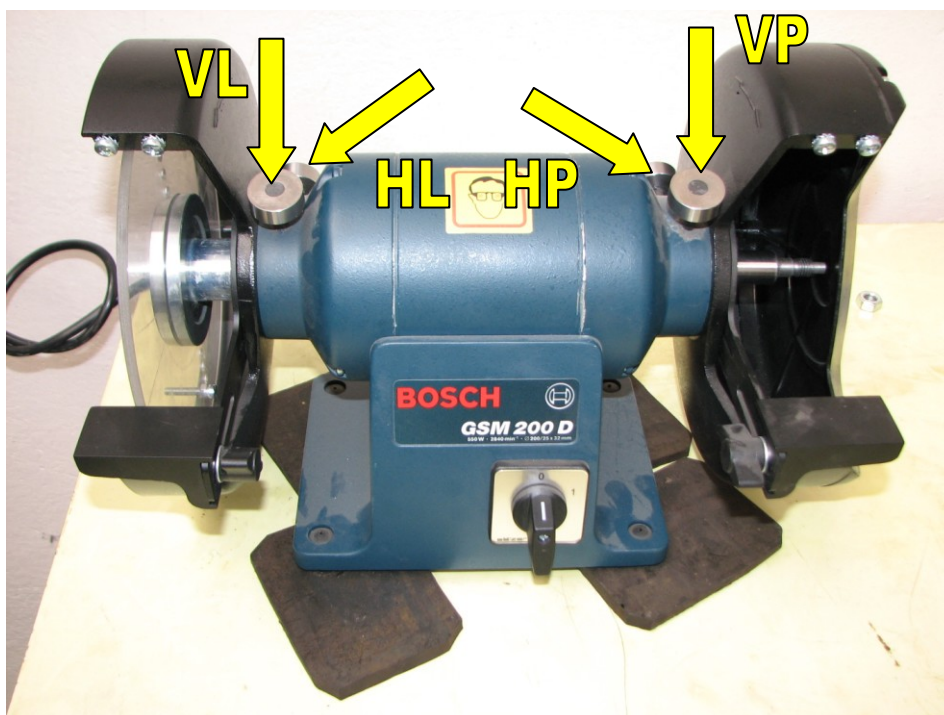
Obr. 21 Umístění měřících ploch na brusce Bosh
