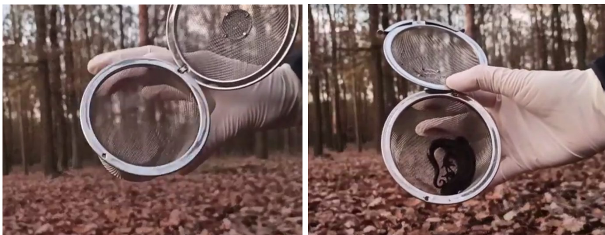
Obr. 7 – Příprava umístění nejprve kontrolních nerezových kontejnerů, poté pozitivních
