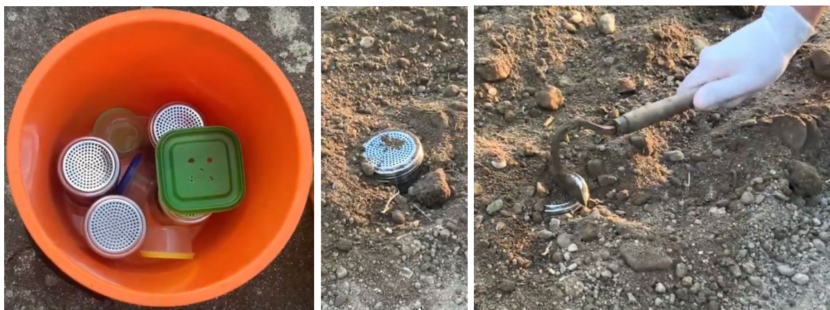
Obr. 6 – Ukázka přípravy terénu se začleněnými kontejnery pod zeminu (vlevo 8 negativních kontejnerů, vpravo pozitivní kontejner)
