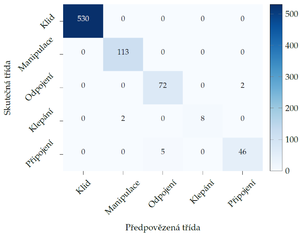
Obr. 3.3: Matice záměn vyhodnocená na testovacím souboru dat po učení, která ukazuje skutečný výkon navrhované metody klasifikace událostí.
