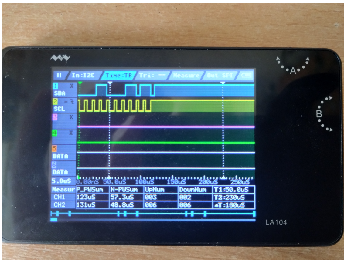
Obrázek 7.5: Zachycený hodinový a datový signál sběrnice na logickém analyzátoru
