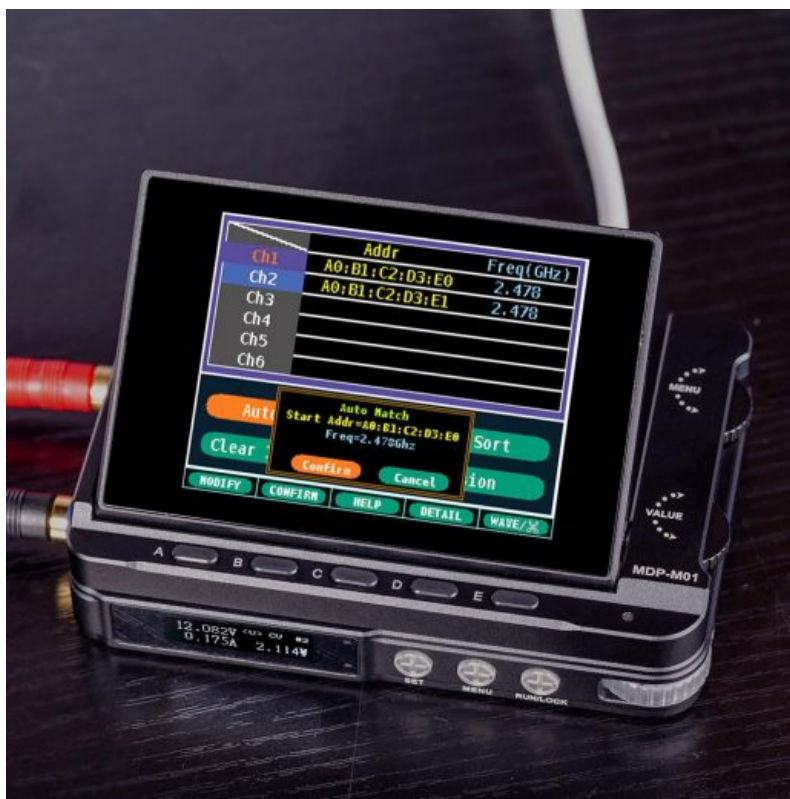
Obrázek 2.2: Miniware MDP-XP. Dolní modul je MDP-P905 a modul postavený na něm je MDP-M01.[6]
