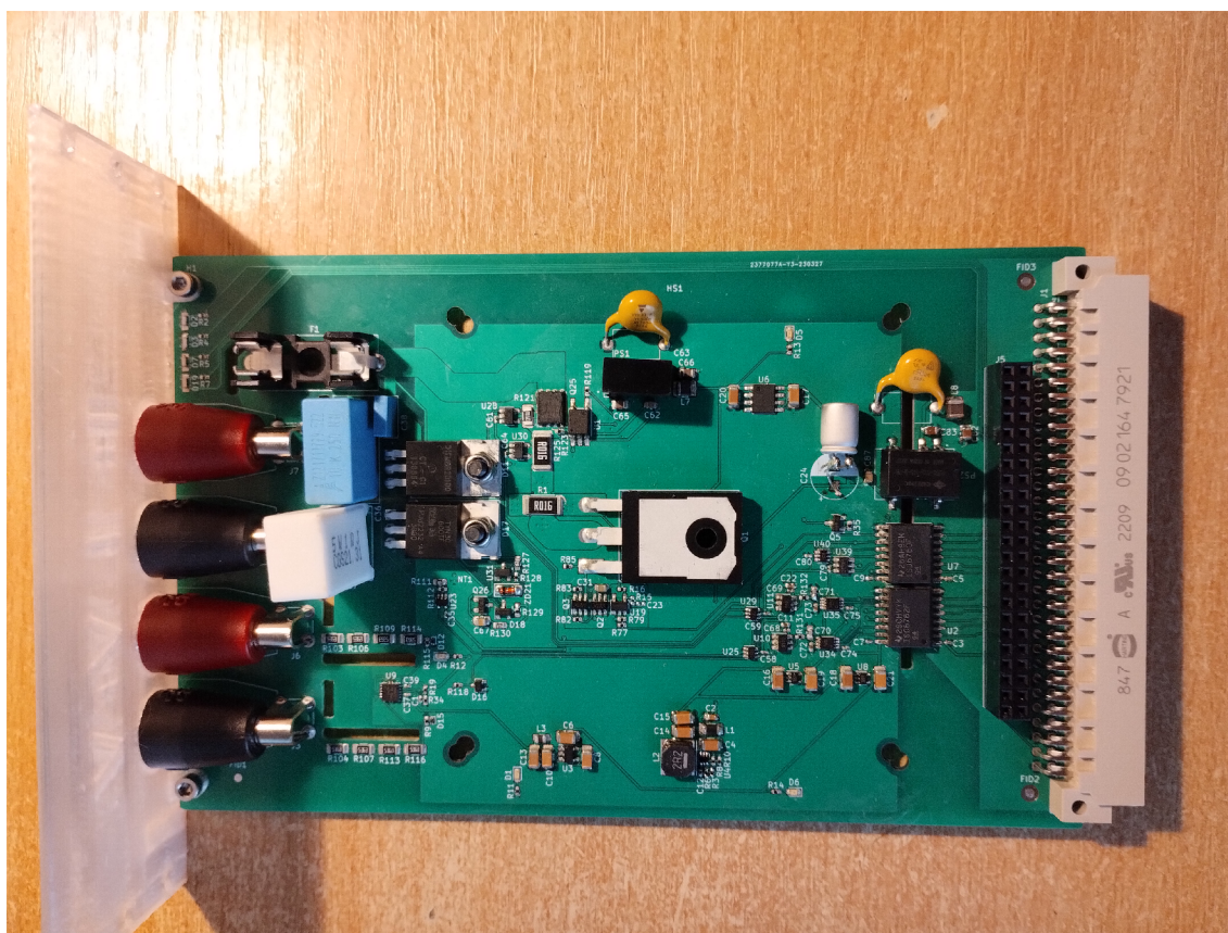
Obrázek 6.10: Modul zátěže před osazením chladiče.
