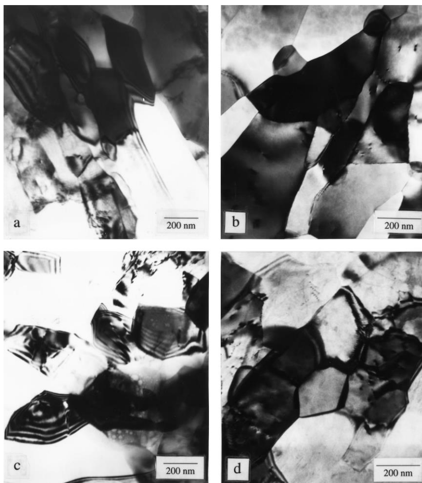
Obr. 7.19: Al slitina 3003 po ECAP a následném žíhání – a) 4×ECAP (průchod A), b) 4×ECAP (průchod A) + 140 °C/1 h, c) 4×ECAP (průchod B c ), d) 4×ECAP (průchod B c ) + 140 °C/1 h [76]
