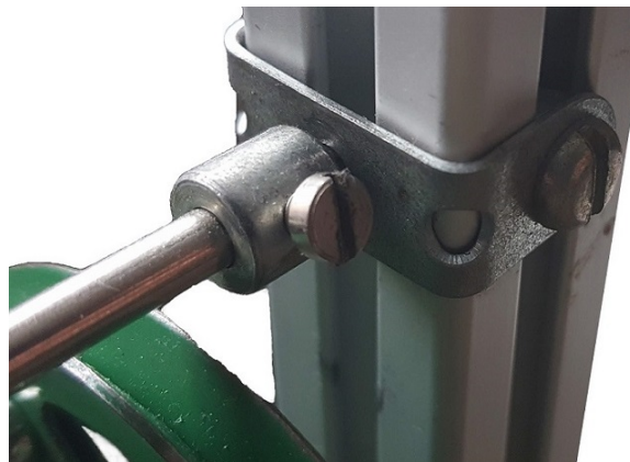
Obrázek 3.18: Detail na uchycení hřídele v levém sloupu
