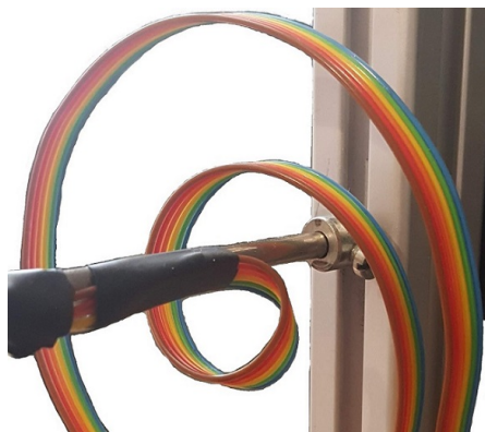
Obrázek 3.19: Detail na řešení namotání vodičů na konci hřídele
