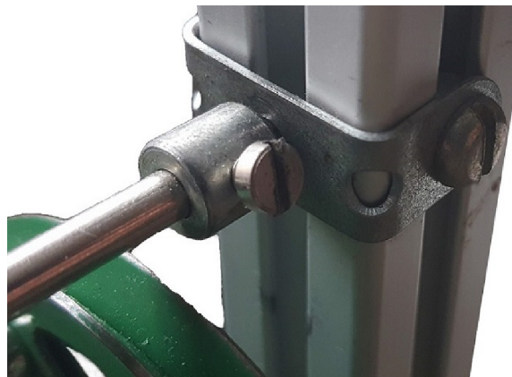
Obrázek 3.18: Detail na uchycení hřídele v levém sloupu
