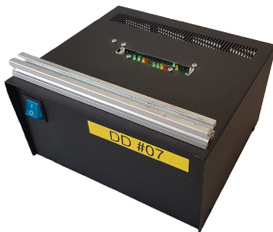
Obrázek 2.6: Modul double drive, bez motorů
