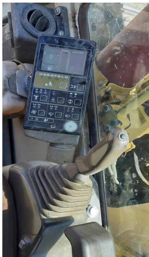
Obrázek 9: Palubní počítač v klasickém rypadle
