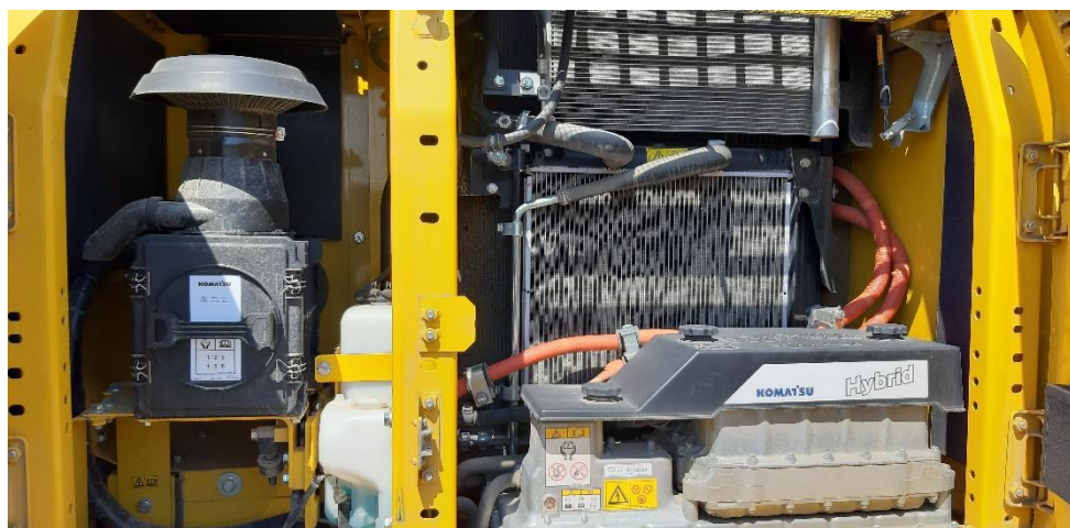
Obrázek 11: Umístění kondenzátoru s usměrňovačem
