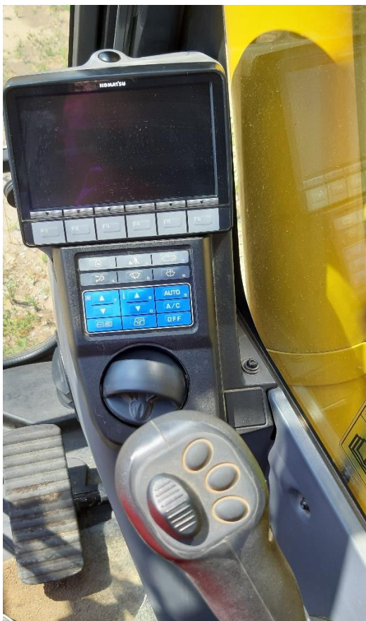
Obrázek 8: Palubní počítač v hybridním rypadle
