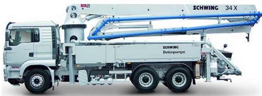
Obr. č. 13 – Autočerpadlo betonu – ilustrační foto
