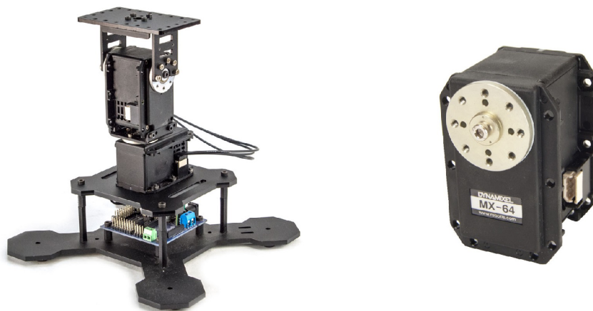
(a) Spojení dvou rotačních aktuátorů [9] (b) Samotný rotační aktuátor [10]
