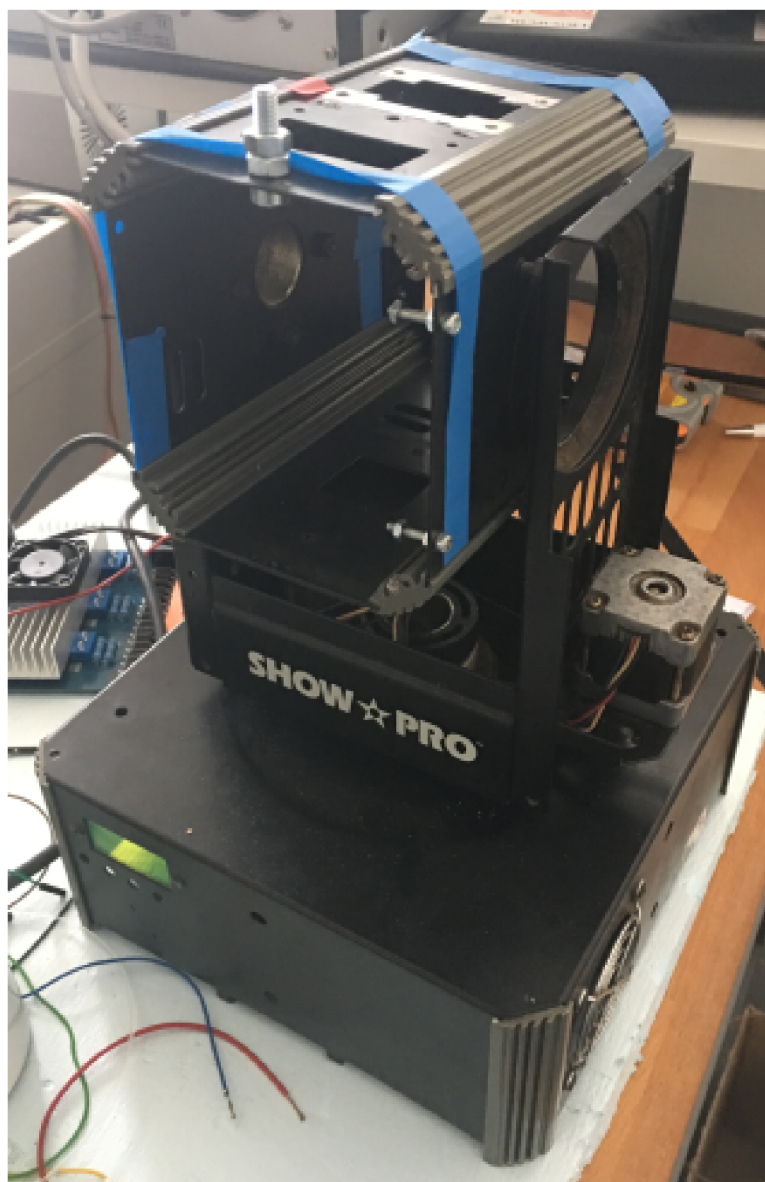
Obrázek 4.1: Prototyp konstrukce robotické hlavy pro účely vývoje
