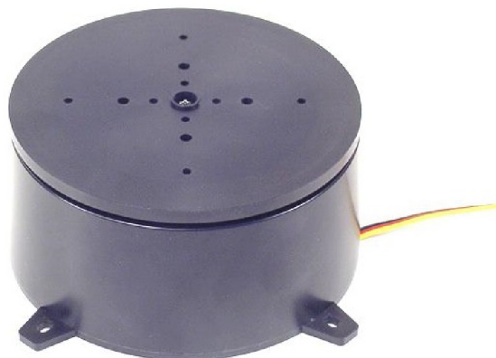
Obrázek 4.8: Plošina s jedním stupněm volnosti base Rotatio kit [16]
