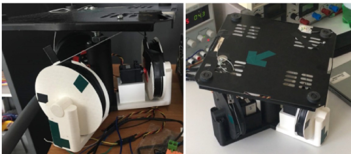
Obrázek 4.17: Sestavená plošina CABLE
