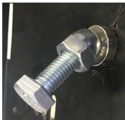
(b) Sférická vazba realizovaná pomocí magnetu
