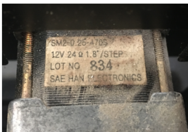
Obrázek 4.2: Štítek krokového motoru upevněného na starém světlometu
