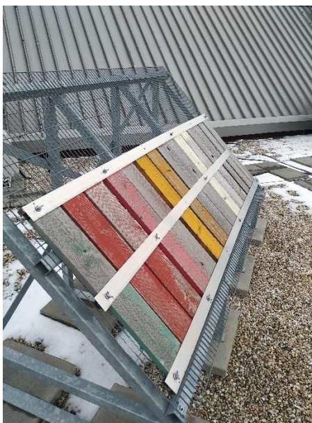
Obrázek 17 Nátěrové hmoty tohoto období a experiment pod vedením Michala Kloibera, vystavení je povětrnostním podmínkám, foto archiv autora
