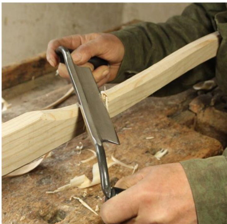
Obrázek 3 Poříz a jeho použití ( https://www.kovetools.com/ 26.1.2022)
