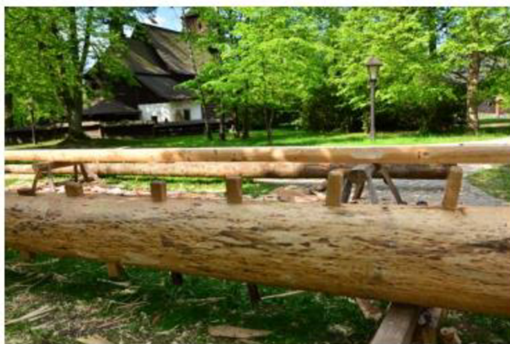
Obrázek 11 Metoda štípání (Kloiber, 2019, 31.1.2022)
