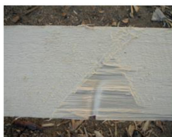
Obrázek 13 Schéma řezu ruční pilou a vznik charakteristického trojúhelníku na prkně (Kloiber,2020)
