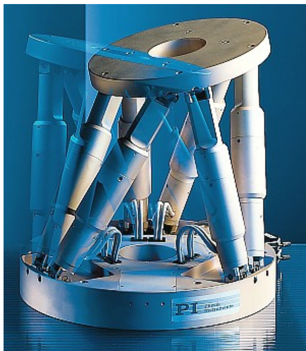
Obr. 2.2. Paralelní manipulátor (hexapod) [5]
