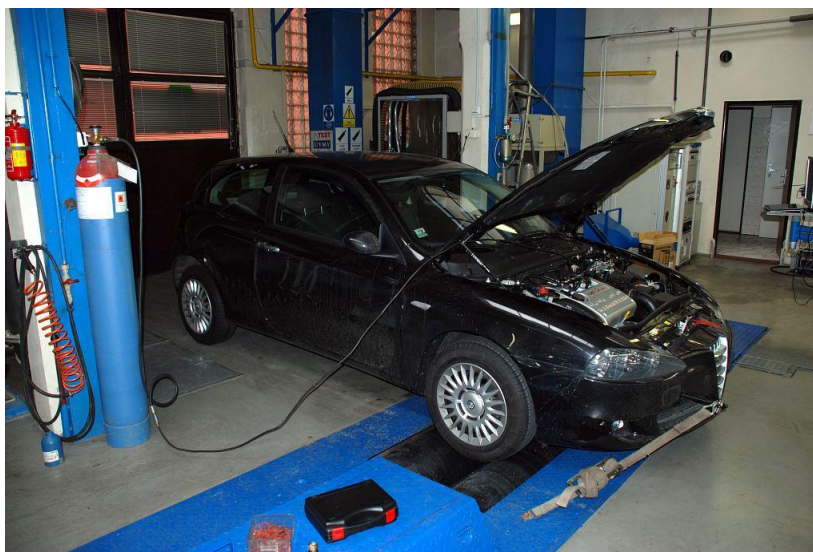
Obr. 12. - Vozidlo na válcové brzdě
