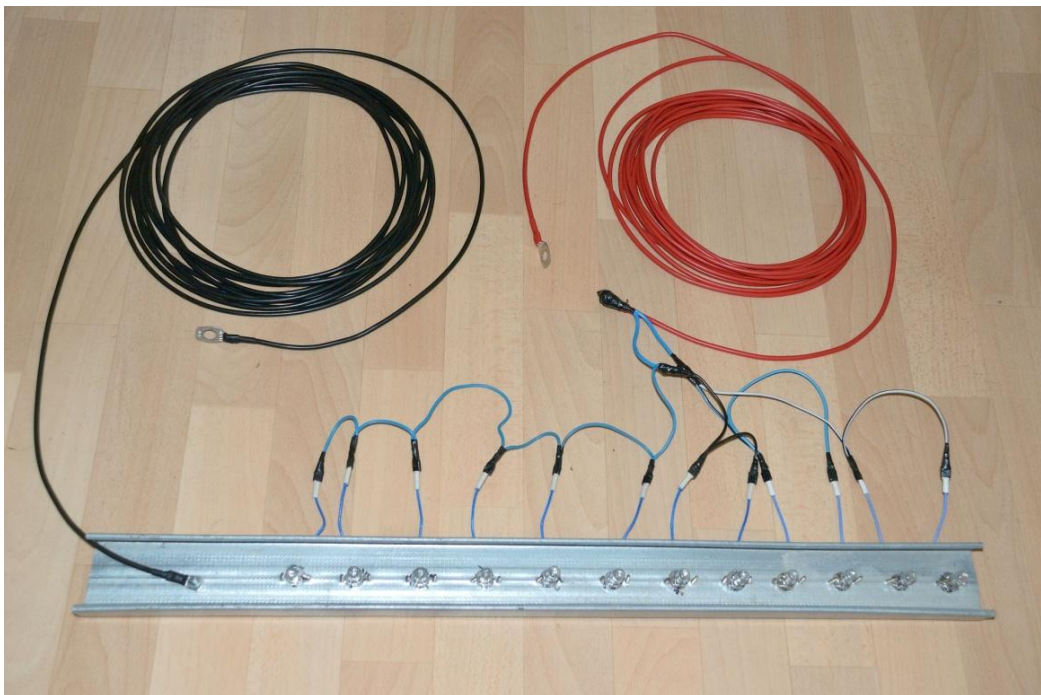
Obr. 50 - Zatěžovací stav elektrické soustavy vozidla, celkový jmenovitý příkon 960 W
