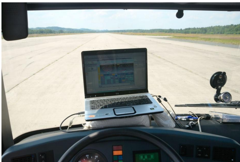
Obr. 35 – Měřicí sestava Adcis Monitor ve vozidle při zkouškách
