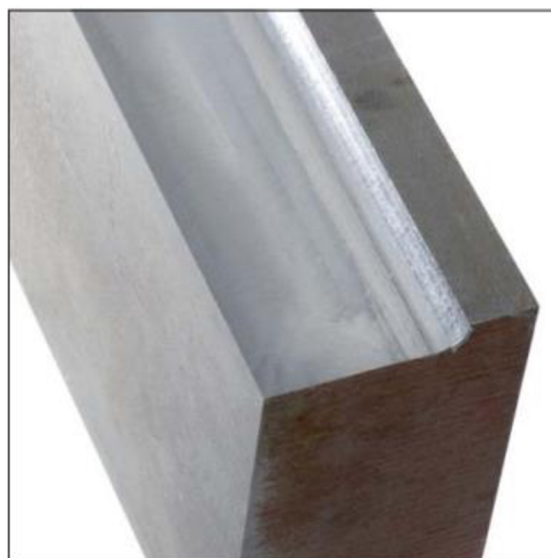
Součást frézovaná s funkcí ACC: Při stejné rychlosti posuvu a hloubce řezu povrch nevykazuje stopy drnčení. Proces obrábění probíhá se sníženým zatížením stroje a nástroje.
