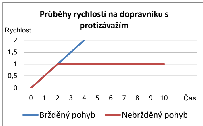
Obr. 6.2.4-1: Průběh rychlostí na karakuri dopravníku s protizávažím
