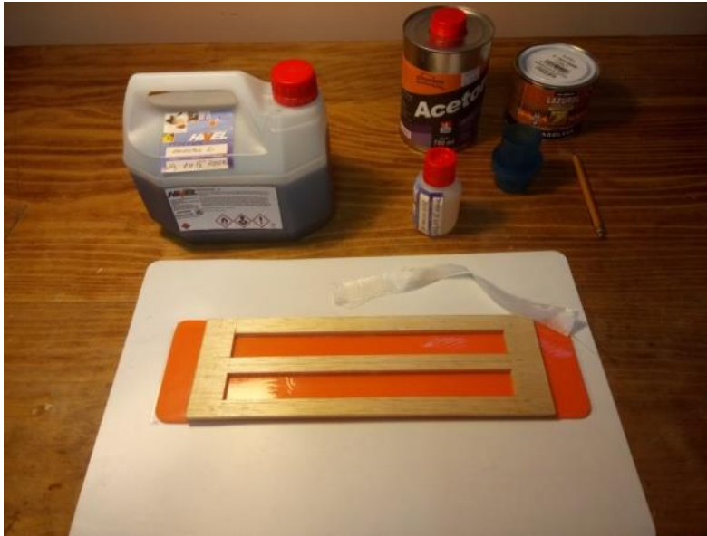
Obr. 8.4.1-1: Výroba kompozitních vzorků pro pevnostní testy
