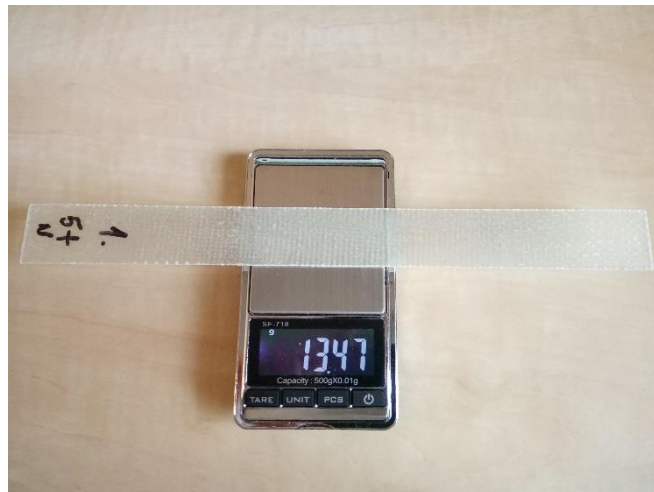
Obr. 8.4.1-2: Vážení poměrů komponent v kompozitním materiálu
