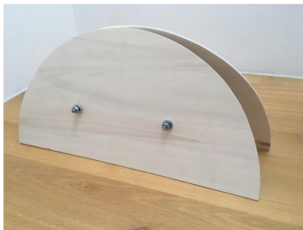
Obr. 8.5.1-1: Šablona pro výrobu tvarové kompozitní pružiny
