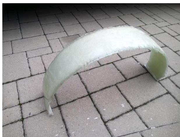
Obr. 8.5.2-3: Kompozitní pružina po vyjmutí z laminovacího kopyta
