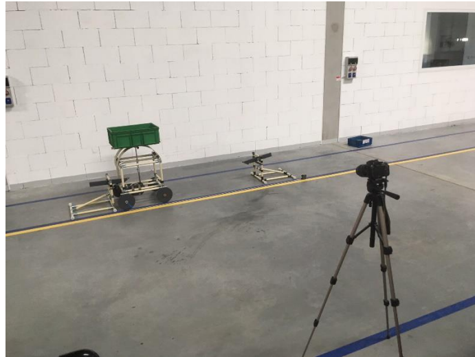
Obrázek 6.4.3-2 Měření ujeté dráhy a času kamerou
