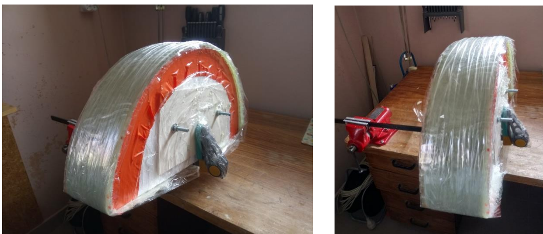
Obr. 8.5.2-2: Vrchní fólie kopyta kompozitní pružiny
