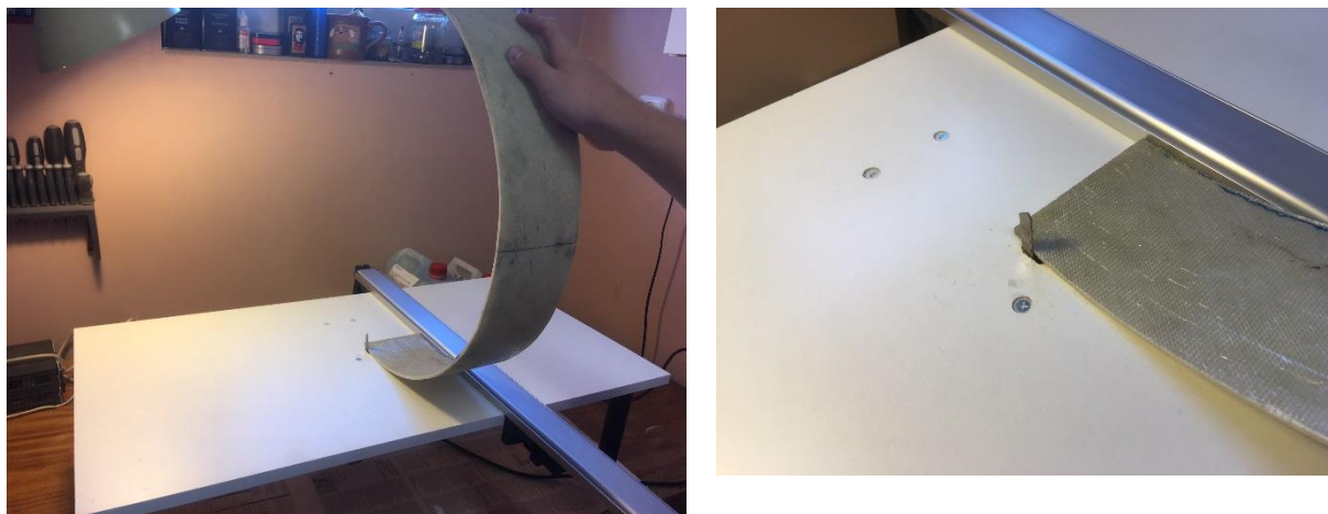
Obr. 8.5.3-1: Ořez technologických okrajů kompozitní pružiny
