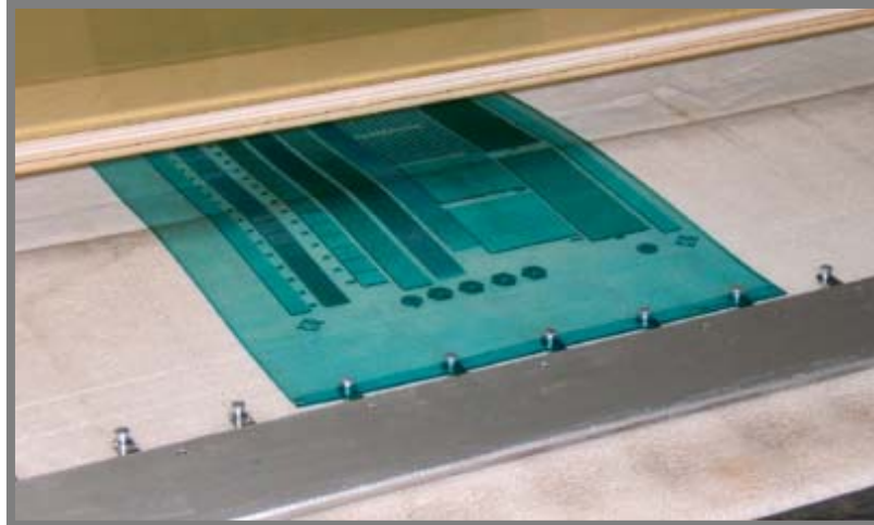
obr. 9: Fotopolymerní deska n výstupu z vymývacího stroje [9]
