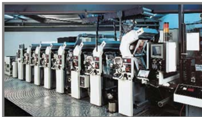
obr. 5: Tiskové segmenty řazené za sebou [4]
