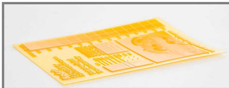
obr. 7: Fotopolymerní tisková deska [9]
