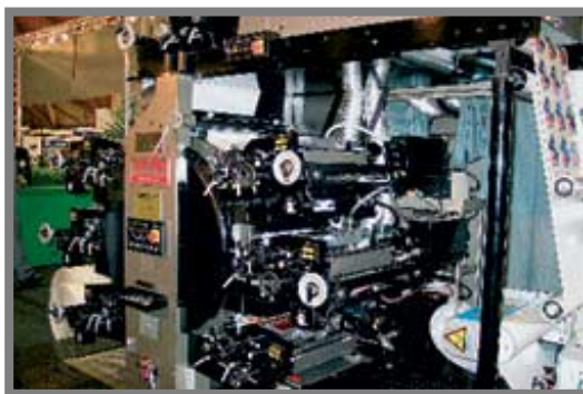
obr. 6: Konstrukce s centrálním přitlačným válcem [4]
