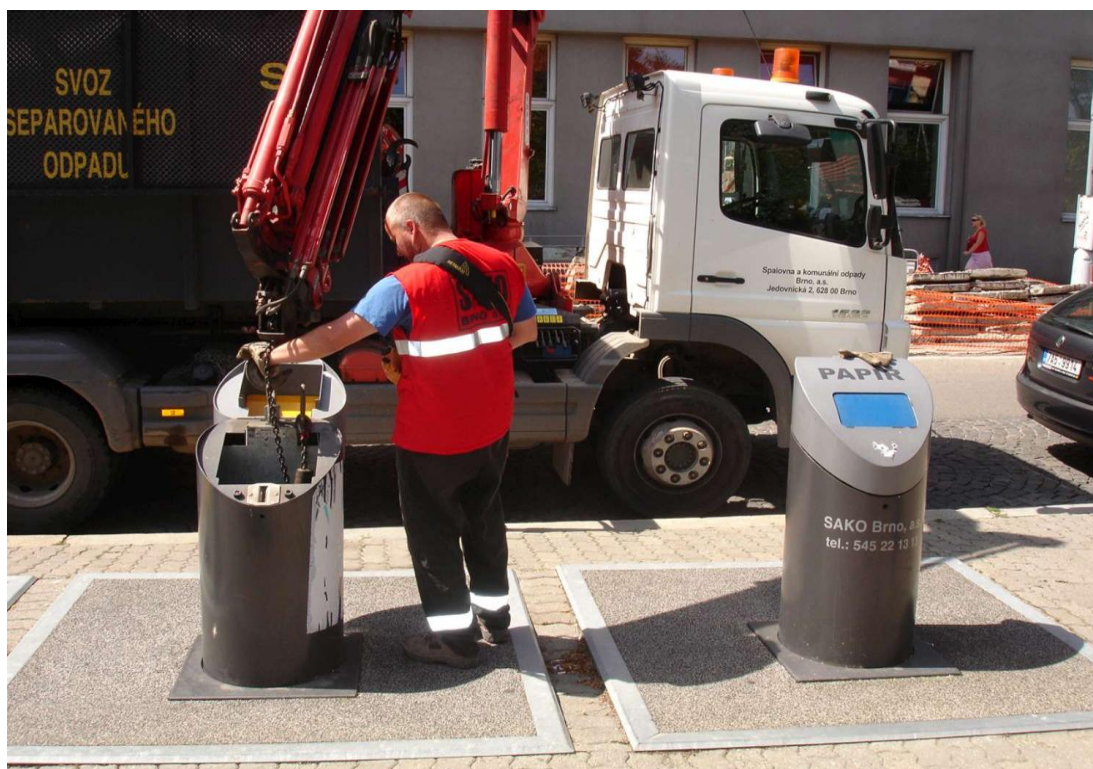
Obrázek č. 6 – Vyprazdňování podzemních kontejnerů
