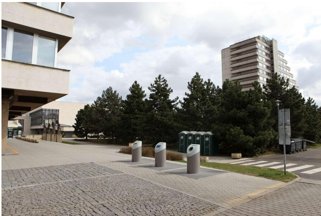
Obrázek č. 2 - Zcela zapuštěné podzemní kontejnery v Mostě
