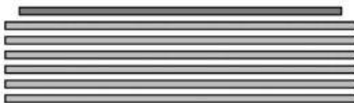
Obr. 2-17 Volné ochlazení vrstev bez vzniku napětí. [31]
