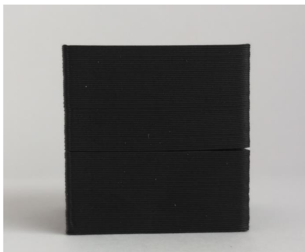
Obr. 5-7 Delaminace vrstev při použití ventilátoru bez vyhřívané komory.
