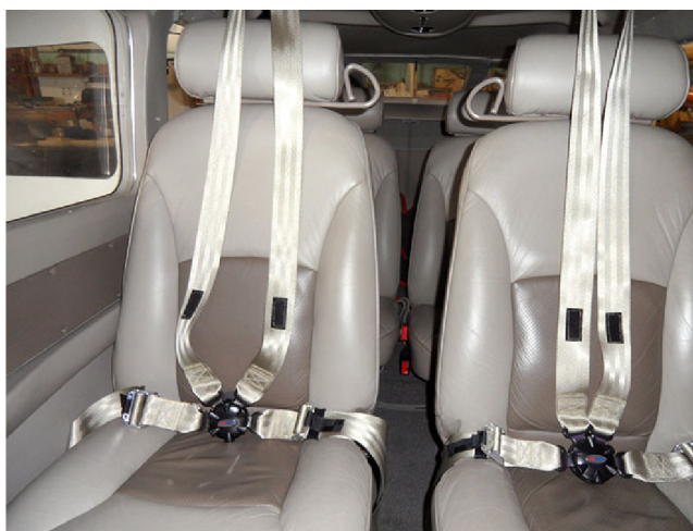
Obrázek 25: Čtyřbodový pásový systém s kulatou sponou od firmy BAS [36]
