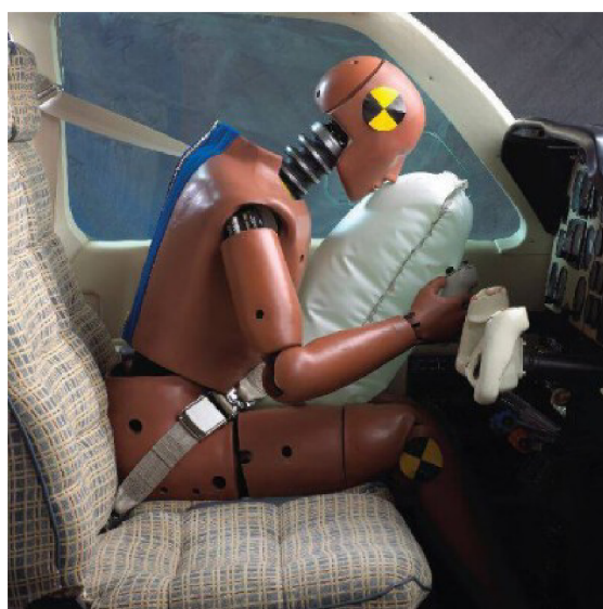
Obrázek 27: Systém airbagů pro pilotní kabinu od společnosti Aircraft Spruce & Specialty Co. [38]
