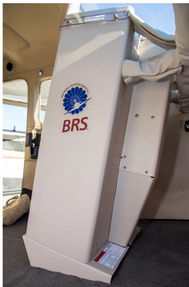
Obrázek 24: Balistické odpalovací zařízení umístěné na palubě letounu [32]
