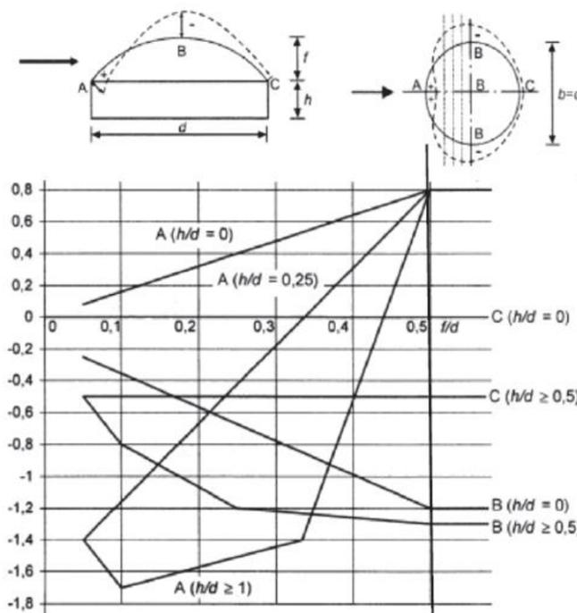
Rozdelenie oblúku na časti s jednotlivými súčiniteľmi  $c_{pe}$
