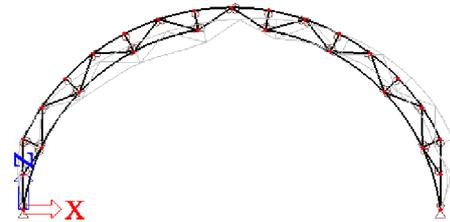
Stále zaťaženie (ZS1 + ZS2)..... $u_{z1} = 5,8$  mm
