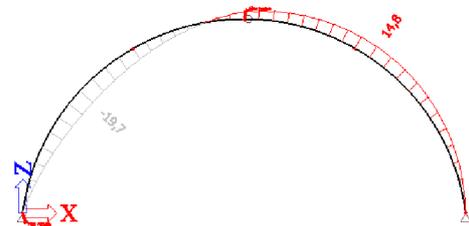
Stále zaťaženie (ZS1 + ZS2)..... $u_{z1} = 6,5$  mm
