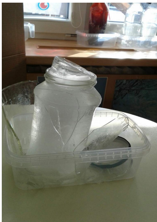
Obr. 17 – Sklenice, která praskla pod tlakem rozpínání ledu
