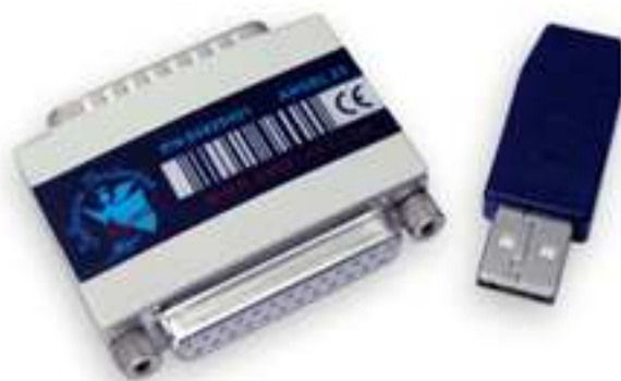
Obrázek č. 2: podoba hardwarového klíče – paralelní port a USB konektor ( http://www.identcode.cz/Select_ang.asp )
