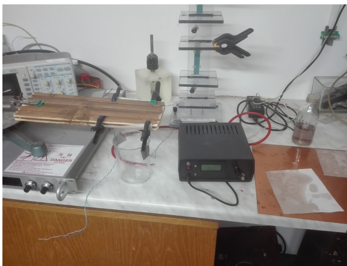
Obrázek 3.3: Zařízení pro zjištění šířky tmavé části upraveného filtračního papíru zasaženého ozonem, který generuje šroubovice.
