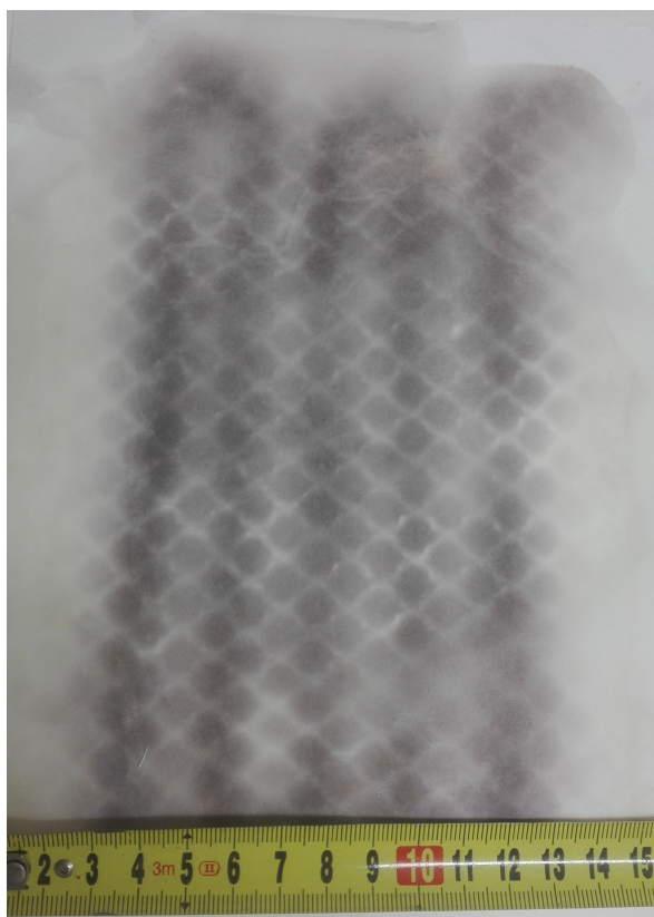
Obrázek 3.14: Obarvený filtrační papír po 30 sekundách působení ozonu
