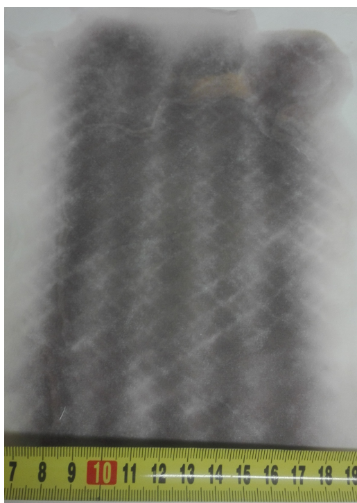
Obrázek 3.16: Obarvený filtrační papír po 60 sekundách působení ozonu
