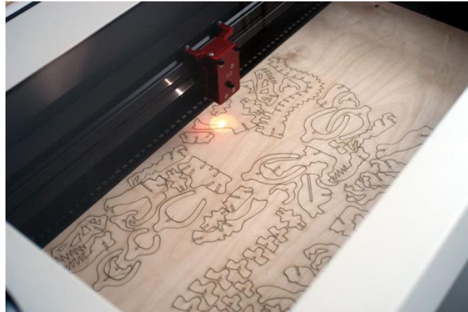
Obr. 13 Řezání překližky laserem
