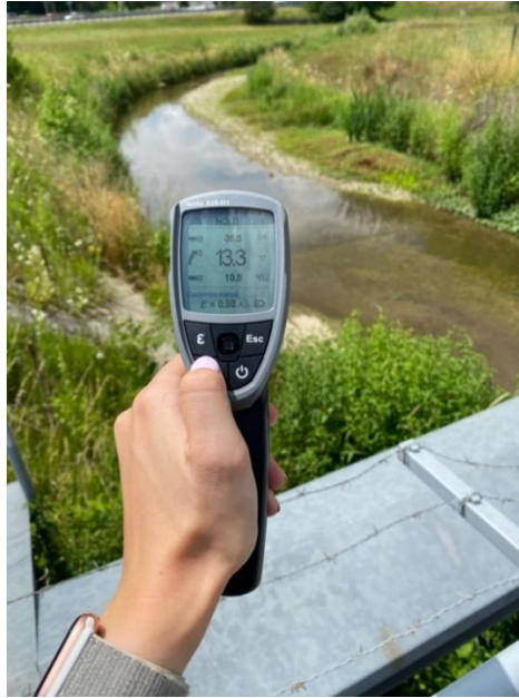
Obrázok 1: Ukážka merania pomocou IR teplomera (Testo 835-T2) na vodnej ploche
