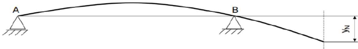
Obr. 27: Průhyb vřetene zatíženého silou F za předpokladu, že ložiska jsou tuhá [32]
